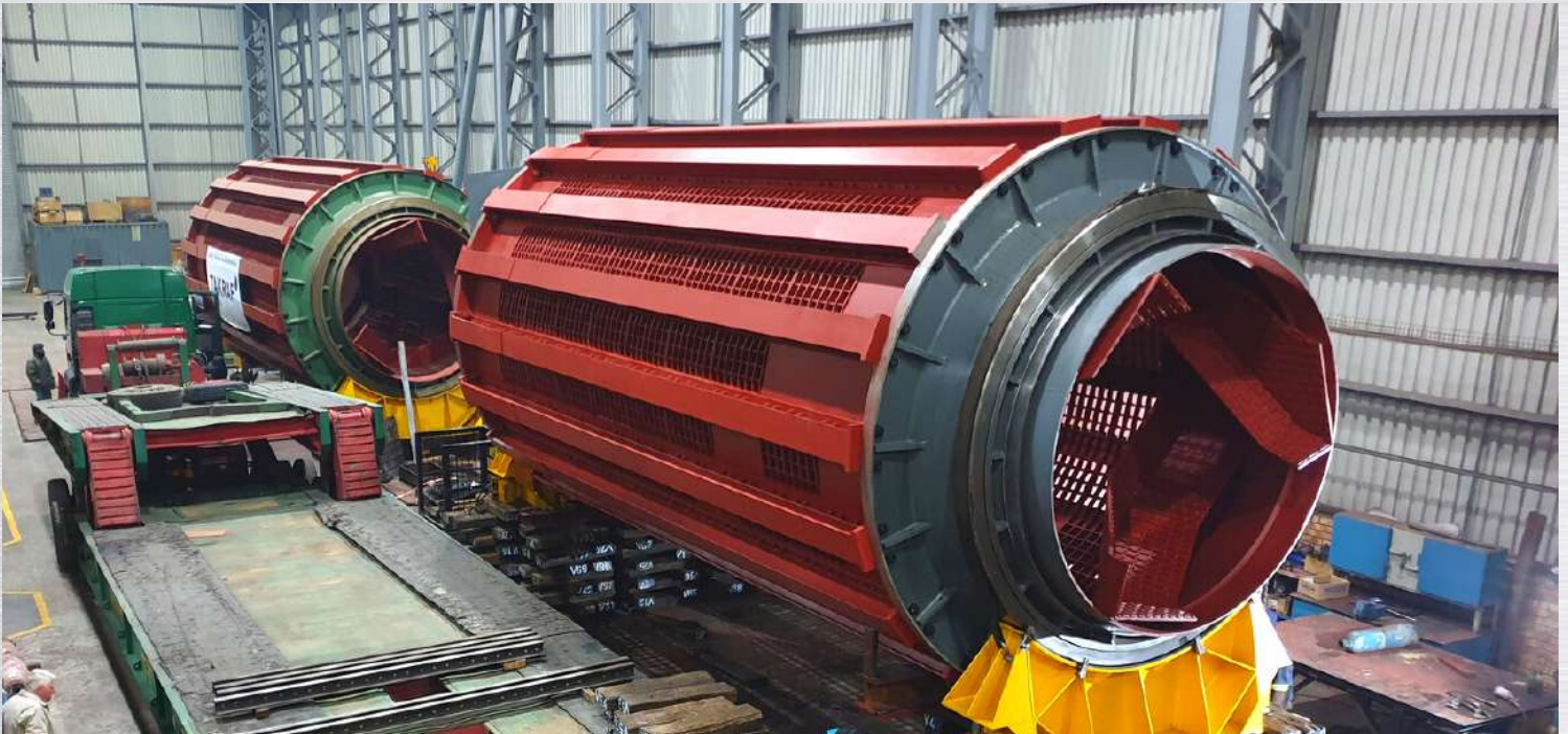
4.2 Meter x 8.5 meter Bradford
